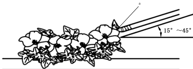
图 3 防火性能测试示意图
